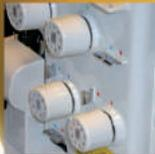
Les guides codés en couleur sur la machine rendent l'enfilage facile et efficace. Le réglage de tension rotatif est un système éprouvé pour un réglage facile et fiable.
